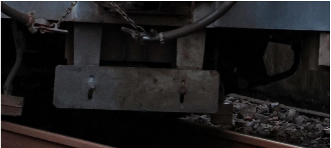
↑ 2092 号機と同じで、保護板の角が 45 度削られている ↑
