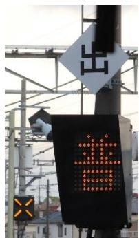
表示が出るタイミングは、発車合図が鳴った時で、列車が発車して、列車の先頭部が装置の横を通り過ぎ、少しすると消灯するようになっている。
