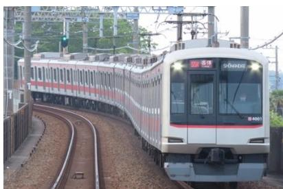
このタイプは4101F・4102F・4104Fが該当します。側面窓下の赤帯が太く、6号車に5000系(4101Fから順番に5918, 5919, 5921)が組み込まれています。相鉄新横浜線開業前の試運転で相鉄に貸し出されていた4102Fと4104Fはこのタイプです。
