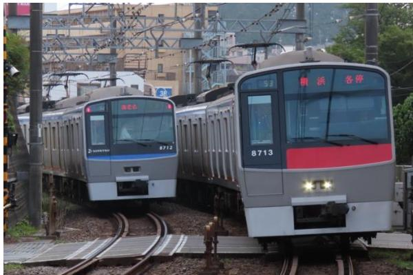
8000系は1990年から1999年にかけて日立で製造された車両です。相鉄車として初めてスカートを設置し、新6000系以来となる拡幅車体で製造されました。
