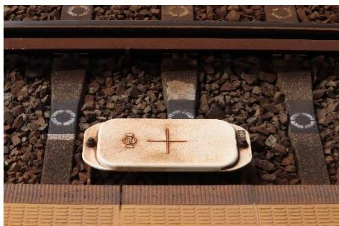
車が停止位置を通り過ぎたときに、非常停止信号灯が点灯、列車が非常停止するようになっている。
