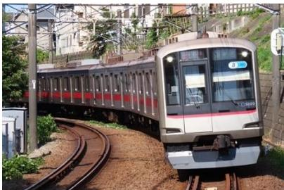
このタイプに該当するのは 5189F と 5190F です。6両時代はタイプ④と同じ形態でしたが 8 連化時に 4 号車に組み込んだ車両が大井町線 Q シート導入時に余剰となったデハ 6301 とデハ 6302 を総合車両製作所にて改造しそれぞれデハ 5489 とデハ 5490 となっています。
