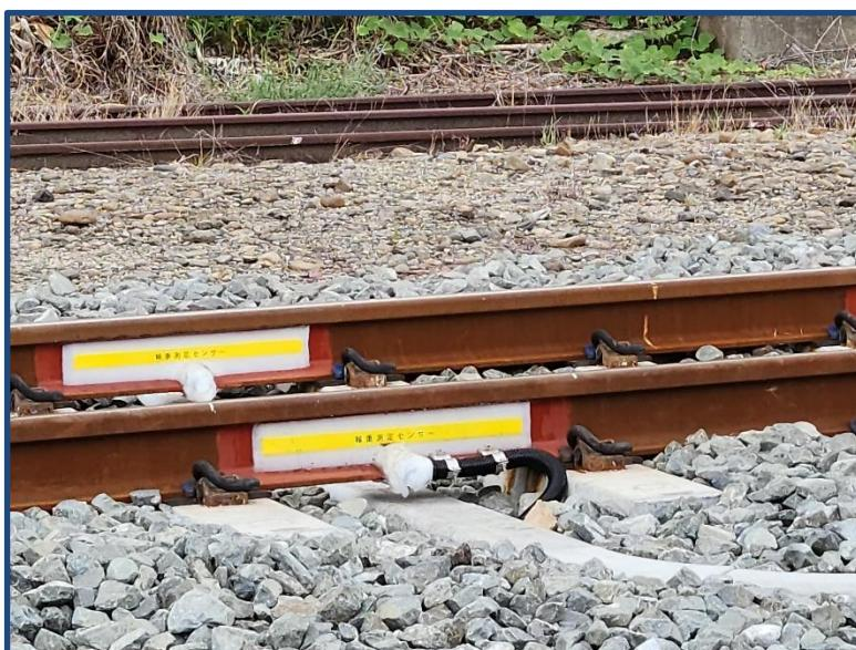
カーブの途中に上の写真のようなものが線路に取り付けられています。これは右の写真の機械と繋がっていてここを通過すると、その貨車のバランスが適正に保たれているかどうかが測定されます。測定結果は担当者に送信されるようになっています。
