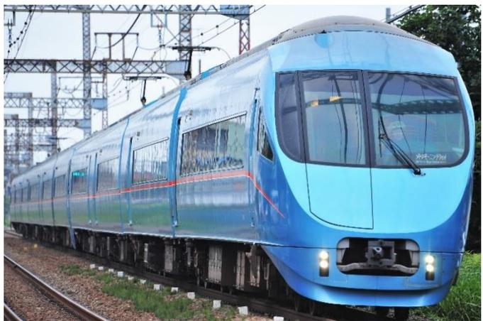
50000形(VSE)と同様に岡部憲明氏が担当している。地下鉄に直通運転するため、展望席はない。先頭車の前面の形状は2種類存在し、6号車と7号車(いずれも貫通型先頭車)同士で併結して運転することもある。そのため、10両編成を6両と4両に分割が可能である。左側の写真の先頭車(1号車と10号車)正面には非常用の貫通扉を設けている。2008年3月15日に営業運転を開始した。当初は6両編成が2本と4両編成が1本のみであったが、
