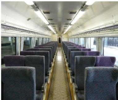
普通車の席はR51Nというものを使用している。これは、先述の背面テーブルなしの簡易リクライニングシートで、最大15°傾けることができるが、体勢を変えるとリクライニングが戻ってしまうというものであった。(後の改造でロック機能が付いた)生地は青色、横引カーテンを使用している。座席間を広く使うために背面テーブルを廃止するという、思い切った簡略化もされている。
