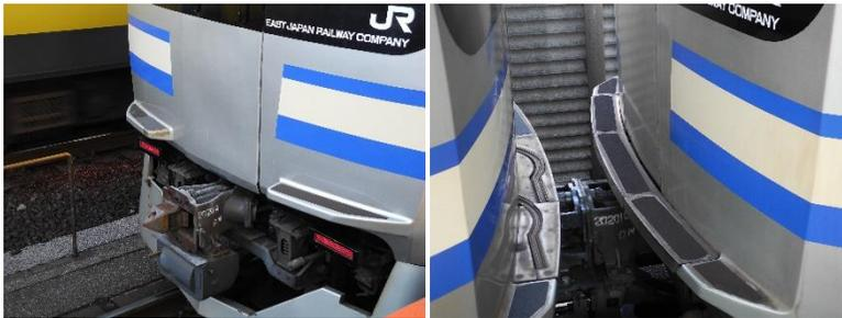
左は量産先行車 Y-1 編成のドアステップ。真ん中のステップがない。一番右のドアステップはドアレールがない。右の写真の左側のステップが一般的。
