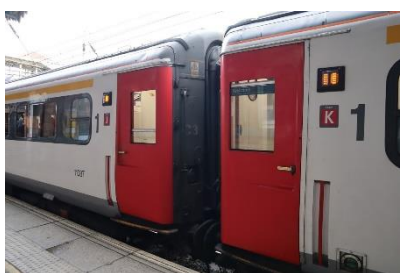
▲ドアが開き戸になっている
