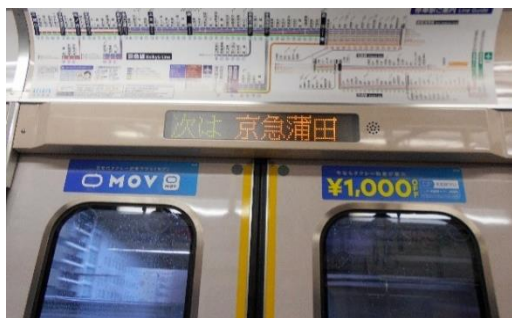
△未更新車の文字スクロール式の案内器。 今後LCD化するだろう。
