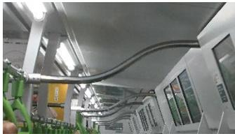
車両強化のため、車内の手すりと垂直方向にバーが張り巡らされている。
