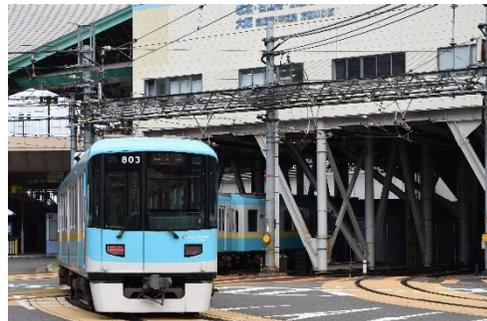
京津線は急勾配・急曲線が多い路線であり、上栄町駅～びわ湖浜大津駅は併用軌道となっている。さらに東西線に直通するには地下鉄車両の基準も満たさなければならず、両線を直通するため様々な設備や最新の装置が搭載された。急勾配・急曲線・併用軌道に対応した台車や車体、ブレーキ装置はもちろん、京津線のATS装置に加え東西線のATC・ATO装置やホームドアにも対応、地下鉄の低い架線と併用軌道の高い架線に対応した京阪初のシングルアーム式パンタグラフ、IGBT素子を使用したVVVF制御装置の採用など高性能な4両編成の電車となっている。外観は京阪本線7200系を縮小したもので、先頭車2両は固定セミクロスシートとなっている。塗装は800系のオリジナルで、琵琶湖をイメージした水色とアイボリーの地に、京津線のラインカラー「荊安色」(黄色)の帯が延びている。なお、2017年より京阪本線の一般車の塗装に順次変更されている。
