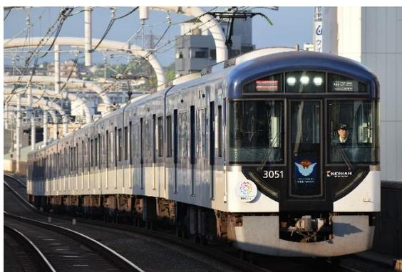
▲前面液晶ディスプレイ設置後の3000系ロゴと車番の位置が変更され、中央には伝統の「鳩マーク」が表示されている。時々鳩が飛んでいくようなアニメーションも表示される。
