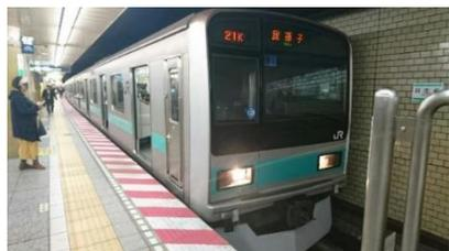
209 系(写真は地下鉄千代田線直通対応の 209 系 1000 番台。この顔は、地下鉄東西線直通対応である E231 系 800 番台にも受け継がれた。)
