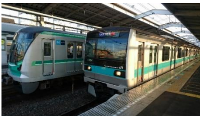
E233系(写真右。写真は地下鉄千代田線・小田急線直通対応のE233系2000番台。)
