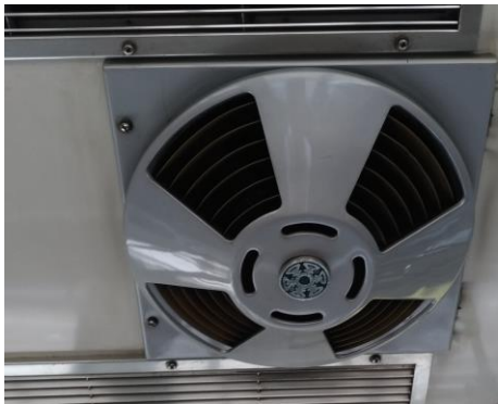
▲ 現在も残る回転グリル 社章の付いたカバーが回転する。
