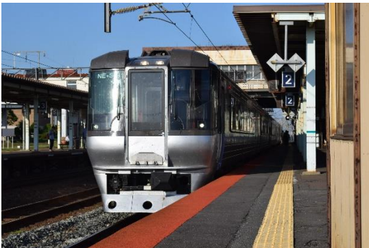
▲乗車した 785 系特急「すずらん」。2 本しかないためレア。 ▲先頭車を中間車改造している
