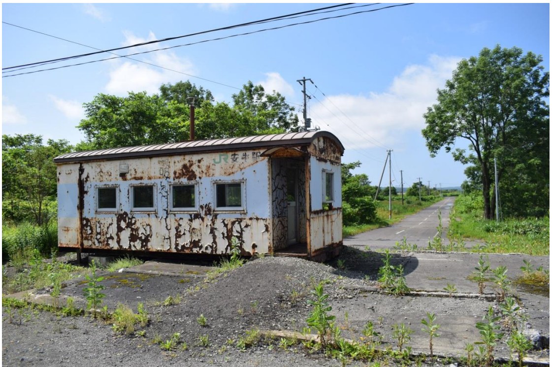
▲腐食が進んだ車掌車の待合室と無人地帯になった右の奥の駅前通り
