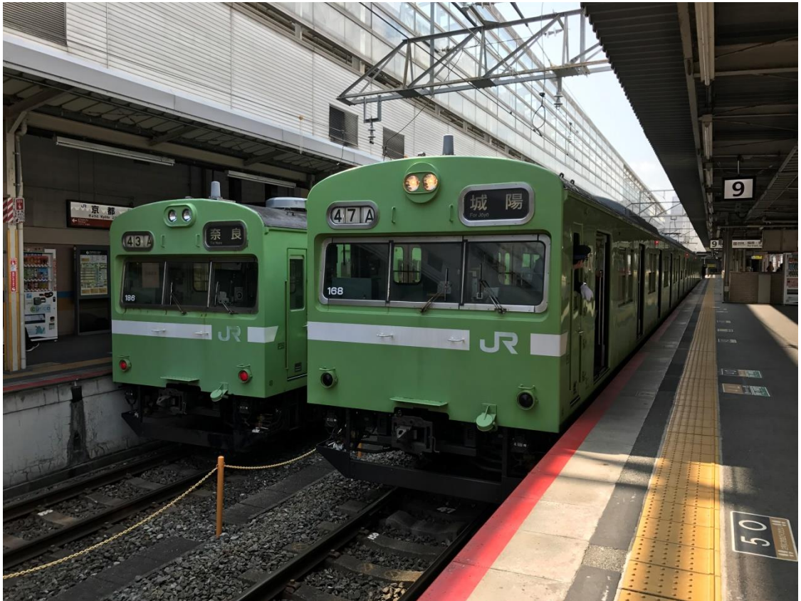
▲左が普通の103系、右がレアな103系、ヘッドライトのケースの形が異なっている
