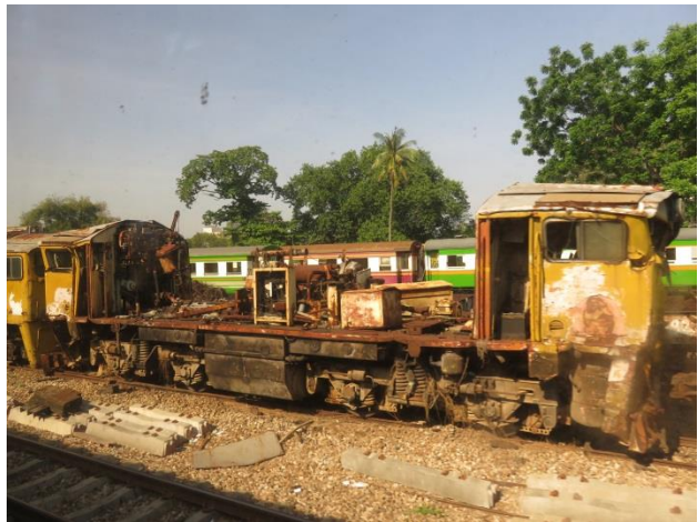
さびて崩れ落ち、外壁が無くなった機関車
