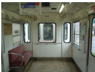
塞がれた貫通扉
