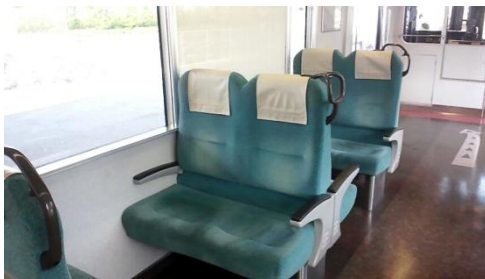
セミクロスシート（ボックス部分） 甲府駅にて
