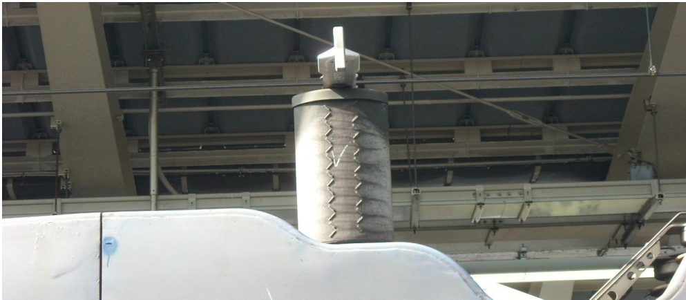
中央に見える柱が「マスト」。マストの中央に見える突起が「ボルテックスジェネレーター」、マスト上部で架線と接触している部分が、「集電舟：翼型舟体」。
