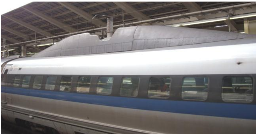
パンタグラフ及び、碍子カバーの全景
