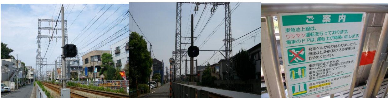
池上線のホーム特殊発光信号機（通常時） 電車接近時の通常時のホーム特殊発光信号機 ワンマン運転、ホーム柵の案内
