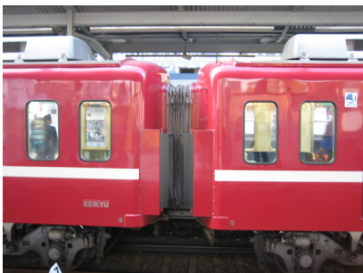
6両化により先頭車が中間車化された
