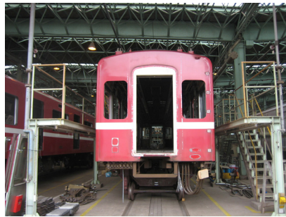
②窓ガラスなどが取り外される
