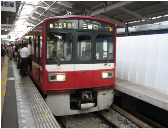
1500 形の VVVF インバータ制御車 (車体前のスカートが特徴)
