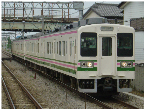
←上越・吾妻・両毛線用 107 系 台車・ブレーキ・冷房装置などは急行形電車か らの流用で、新造経費削減を図っている
